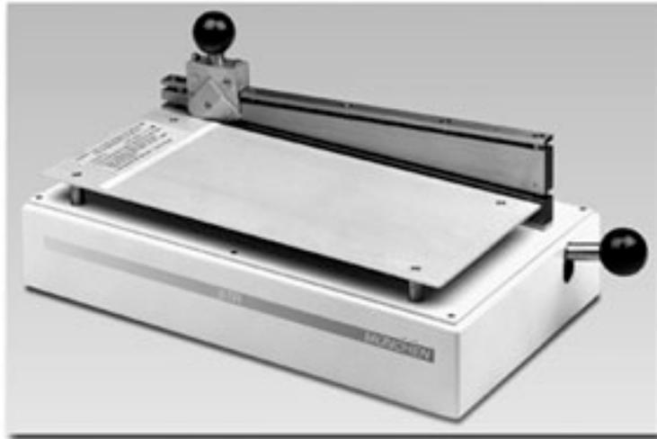
Dieses Präzisionswerkzeug kommt überall dort zum Einsatz, wo streifenförmige Proben aus Folie, Papier, Karton und ähnlichen Werkstoffen hergestellt werden müssen. Das STR ist mit einer Schnittbreite von 15 mm und einer Schnittlänge bis zu 300 mm für das Herstellen von Proben ausgelegt, wie sie z.B. bei der Hot Tack-Prüfung und der Prüfung der Verbundhaftung, Nahtfestigkeit und Zugfestigkeit von den entsprechenden Normen gefordert werden.
