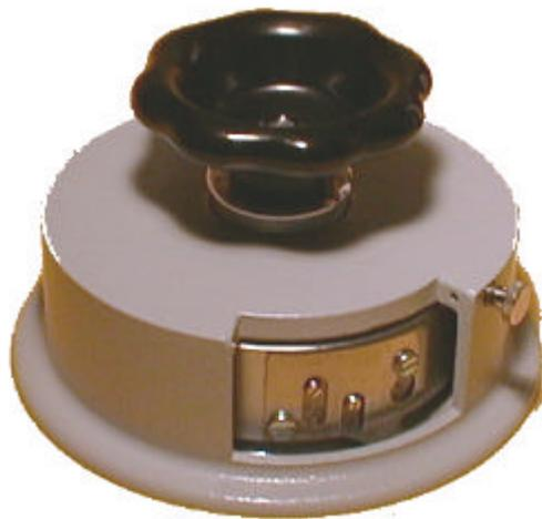
**Nur ein Prüfling mit genau eingehaltenen Flächenmaßen garantiert die zuverlässige Gewichtsbestimmung. Scharfe, kreisförmig angeordnete Messer erzielen im ziehenden Schnitt maßgerechte Rundproben mit absolut glatten Rändern.**
