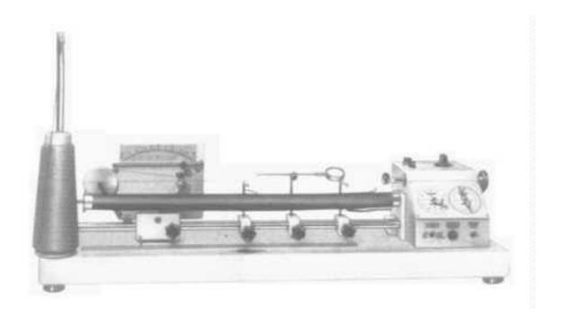
zur Ermittlung der Drehung und einzwirnung von Fäden, Gespinsten und Zwirnen nach dem Aufdreh-, Spannungsfühler- und Marschikverfahren
