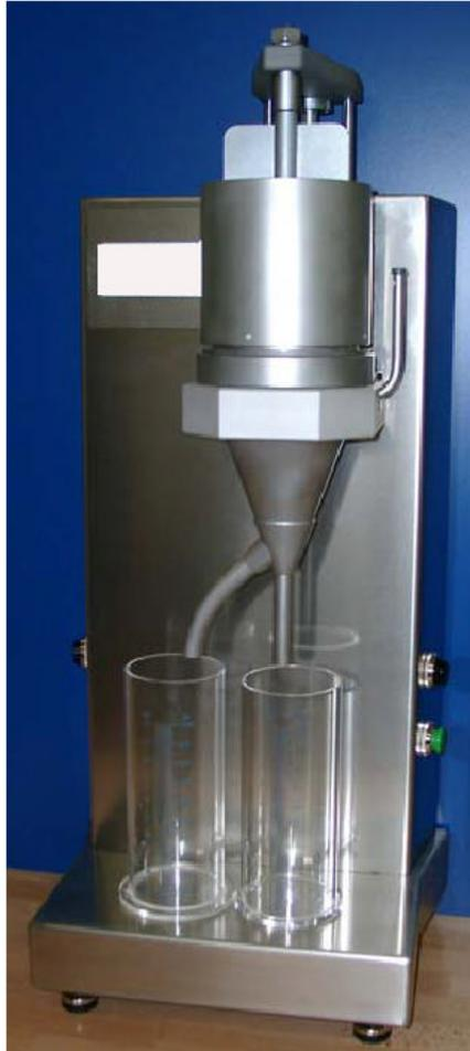
**Schopper-Riegler Mahlgradprüfer - Standardgerät mit 2 Plexiglaszylinder**
