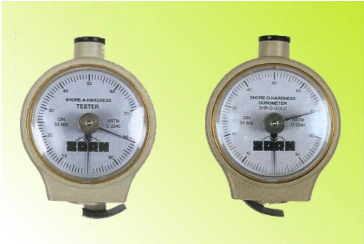
Härteprüfer nach Shore A und D finden Verwendung bei der Prüfung von Elastomeren,
